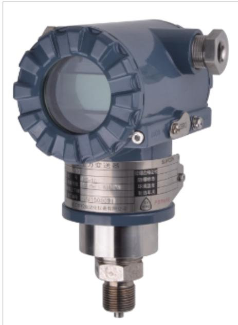
**AT/UAT200型磁致伸缩液位变送器**▲概述UAT200型磁致伸缩液位变送器是利用磁致伸缩原理研制出的新一代高精度液位测量变送器□AT200型磁致伸缩液位变送器是引进美国K—TEK公司的OEM产品□AT/UAT200变送器以捆绑形式固定在UHZ-80系列磁翻柱液位计主导管外侧，与液位计配套使用，实现对液位的高精度测量和远传输出。▲结构原理磁致伸缩液位变送器是基于磁致伸缩原理设计的，它由敏感元件波导丝（管）、活动磁铁及发射电脉冲信号和接收返回信号的电子部件构成。当电子探头中中发生器产生的电冲沿钢管肉的波导丝传递时，电脉冲同时伴随产生一个垂直于波导丝的环形磁场以光速沿波导丝传递。当 $\hat{<}$ 冲环形磁场与浮子固有磁场相遇时，二者的磁场矢量相叠加形成螺旋磁场，产生瞬时扭力并在波导丝上形成一个机械扭力波以声速传递返回到电子探头，使线圈两端产生感应脉冲。通过测量出发电冲与扭力波返回产生的感应脉冲之间的时间差，就可以精确地计算出被测液面高度。同时将温度传感器置于测杆肉，便可连续测定介质温度。采购差压液位计，找常州昂晟！甘肃导波雷达液位计采购工业远传仪表
